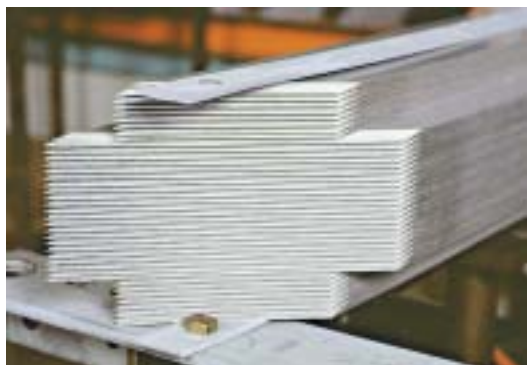
Rdzeń magnetyczny w trakcie montażu
