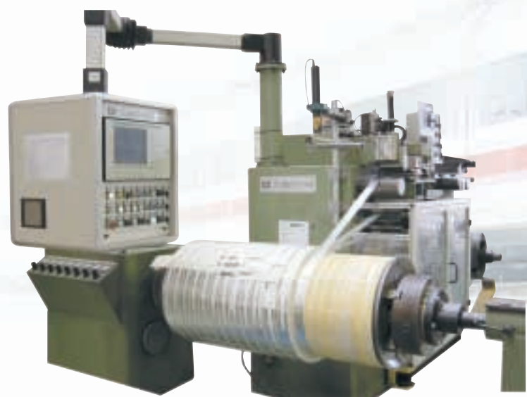
Wspomagany komputerowo proces wykonywania uzwojeń
